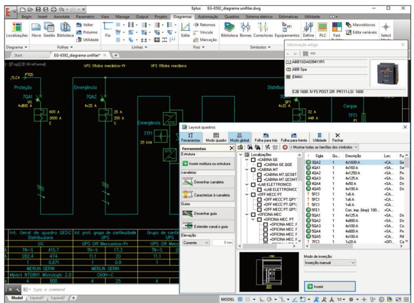
adequadas. Conexão bidirecional com Ampère para o cálculo da rede. Geração automática do esquema unifilar ou multifilar e do esquema radial na seqüência do dimensionamento efetuado no Ampère.
